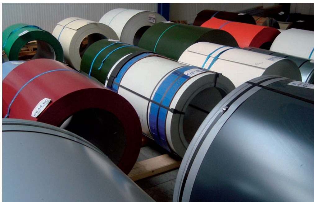
Voorgelakt staal op voorraad bij een Service Center. De profileurs maken veelal gebruik van de diensten van een Service Center, onder meer voor het slitten van de coils.
