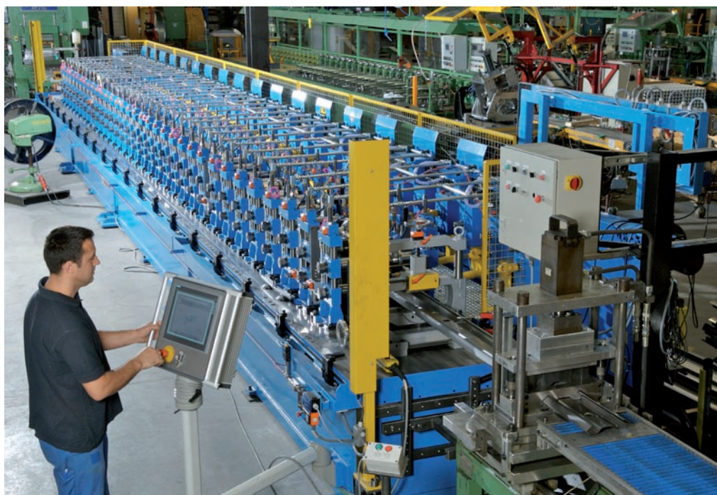
Een van de paradepaardjes van Overeem in Ede: de P4-wals. Deze wals is met 36 vormstations geschikt voor complexe en relatief grote profielen. Deze profileerlijn wordt onder meer gebruikt voor grote verlichtingsarmaturen uit voorgelakt staal. De lijn is geschikt voor materiaal met hogere treksterkte en voor grotere materiaaldiktes, ook in voorgelakt staal.
